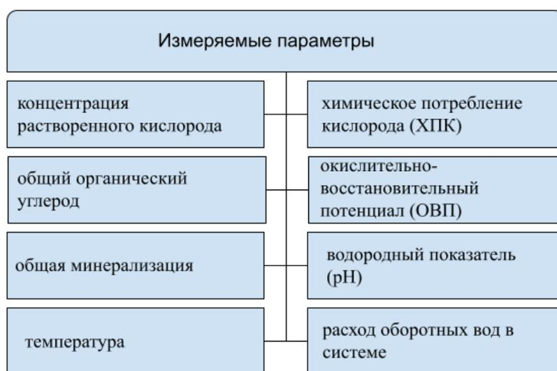
**Рисунок 3. Технологические параметры измеряемые ИИС в УЗВ**
